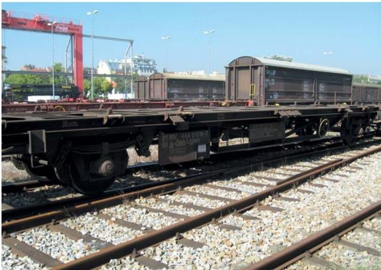
Abbildung 11: Containertragwagen<sup>21</sup>
