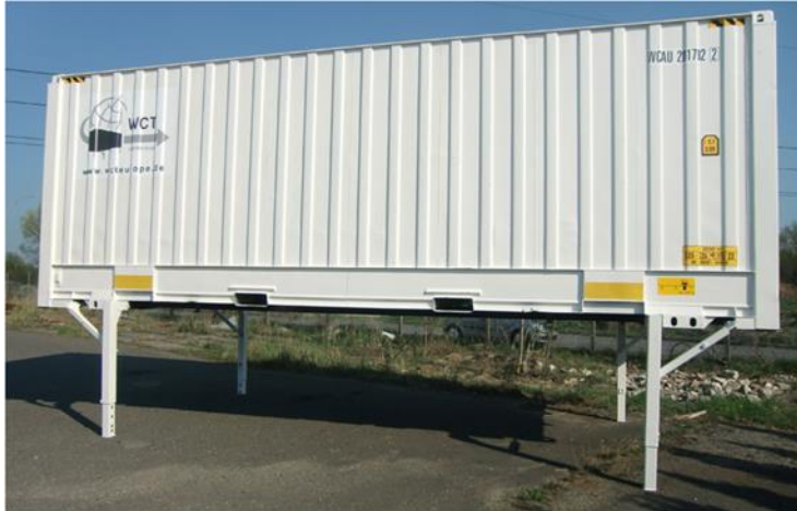
Abbildung 14: Wechselbehälter in Kofferbauweise 33
