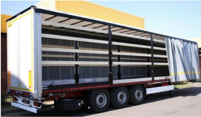
Abbildung 18: Seitlich offener Sattelauflieger mit verschiebbarer Plane
